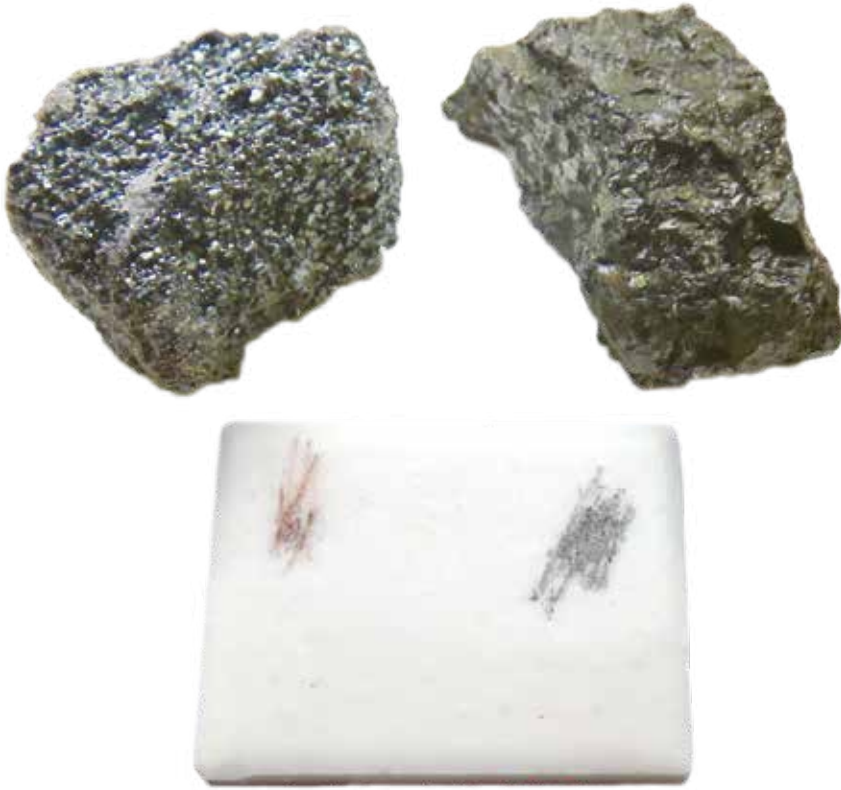
الشكل (14): اختلاف لون حكاكة معدني الماغنيثيت والهيمايت.
