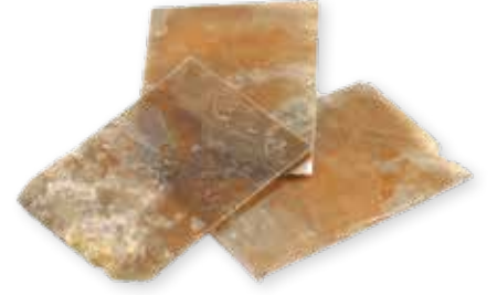
الشكل (16/ أ): معدن المايكا، انقسام في اتجاه واحد.
